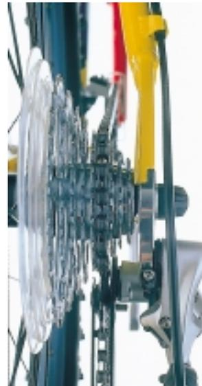
**2** Die **KETTENLINIE** muß stimmen. Sie hängt von den Innenlager- und Kurbelabmessungen ab. Die Kette sollte parallel zur Fahrtrichtung verlaufen, wenn sie vorne auf dem großen Blatt und hinten auf dem vierten (9fach, Foto) bzw. dritten Ritzel (8fach) liegt. Ist dies nicht der Fall, Innenlager gegen eines mit kürzerer bzw. längerer Lagerwelle austauschen. Achtung: Bei einer kürzeren Welle könnten Kettenblätter oder Kurbeln am Rahmen streifen.
