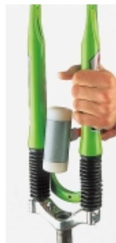
**4** a) Für **ZUGANG ZUM INNENLEBEN** einer Jett entfernen Sie zunächst die Federteller, indem Sie die Gabel auf den Kopf drehen und dann mit dem Schonhammer von unten auf die Krone klopfen, bis aus jedem Standrohr ein schwarzes Kunststoffteil herausfällt.
