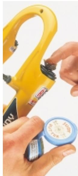
**8** Vor dem **ZUSAMMENBAU DER TAUCHROHR-EINHEIT** fetten Sie den Raum zwischen den Lippen der „Resi-Wiper“-Dichtung am oberen Ende des Tauchrohrs mit der speziellen Judy-Butter oder einem anderen lithiumfreien Fett. Schieben Sie dann die Einheit wieder auf die Standrohre, wobei zu beachten ist, dass die Dichtungen beim Einfädeln nicht beschädigt werden. Anschließend ziehen Sie die Schaftschrauben einer Judy beziehungsweise die Dämpferschäfte einer Jett wieder an (siehe Schritte 4, 4a und b).
