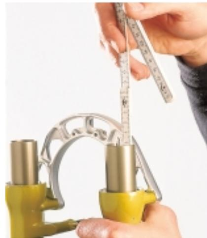
**7** Dann **BEFÜLLEN** Sie bei vollständig einge-schobenem Standrohr, aber ohne Feder, beide Beine der Gabel mit **ÖL DER VISKOSITÄT 7,5**. Mehr-faches, langsames Pumpen mit dem Dämpferkolben füllt die Patrone, bis keine Luft mehr aufsteigt. Schließlich schieben Sie den Dämpferschaft ganz ein. Tauchen Sie einen Maßstab ein, und messen Sie die Höhe des Ölspiegels von der Standrohroberkante. Dies sind die **SOLLWERTE**:
