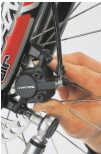
immer nur eine der beiden Befestigungsschrauben und richten den Bremssattel behutsam aus. **CHECKEN** Sie das Hydrauliksystem **AUF DICHTIGKEIT**, indem Sie mehrmals hintereinander den Bremshebel mit aller Kraft Ihres Zeige- und Ringfingers ziehen und für ein paar Sekunden gezogen halten.
