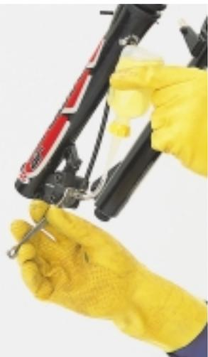
▶ **8** Reinigen Sie alle möglicherweise mit Bremsflüssigkeit benetzten Flächen gründlich mit Alkohol. Dann setzen Sie die Beläge wieder ein, beginnend mit dem äußeren. Das ist der, dessen Fortsatz deutlich aus der Mitte verschoben ist (im Bild der obere). Erleichtert wird das **EINSCHIEBEN DER BELÄGE** bei leicht ausgefahrenen Kolben. Mit einem Pedalriemen lässt sich der Bremshebel dazu in einer entsprechenden Position fixieren.
