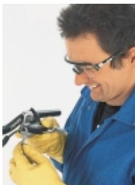
Bestimmen Sie die richtige Länge der Bremsleitung – checken Sie die uneingeschränkte Drehbarkeit des Lenkers! –, und schneiden Sie den Überstand mit einem sehr scharfen Teppichmesser rechtwinklig ab. Dann schieben Sie einen neuen Klemmring auf die Leitung – beachten Sie die Reihenfolge der Teile im Bild rechts –, schrauben die Überwurfmutter zunächst von Hand auf und ziehen sie dann wieder gut fest.
