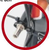
► **4** Als Nachrüstbremse wird die Hayes in der Regel unbefüllt verkauft. Doch selbst wenn Ihre perfekt entlüftet war, nach dem Kürzen der Leitung ist sie es meist nicht mehr. Bevor Sie das System öffnen, **ENTNEHMEN** Sie bitte **DIE BREMSBELÄGE** aus dem Sattel. Sind die
